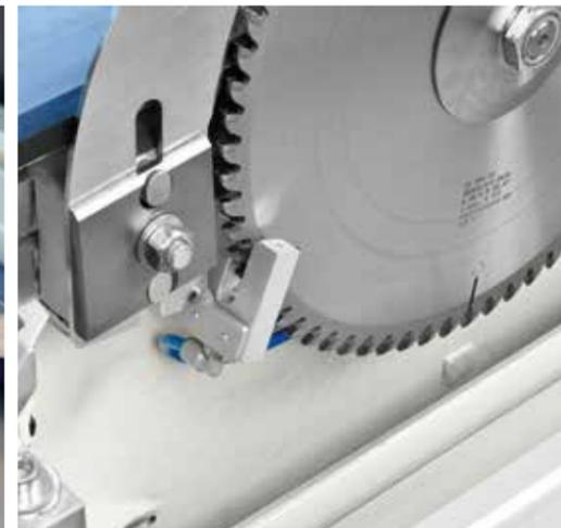
**Vorrichtung zur Mikroschmierung
