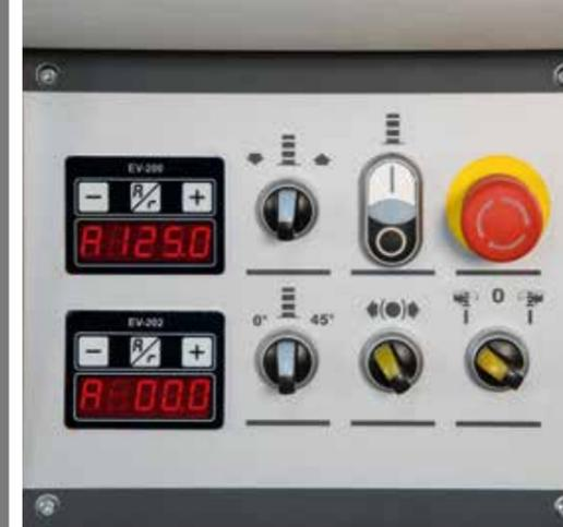
Motorische Verstellung der Arbeitsaggregate mit Digitalanzeige Für größere Präzision und bequemere Anwendung.
