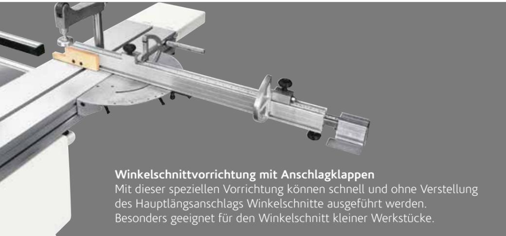
**Winkelschnittvorrichtung mit Anschlagklappen**
