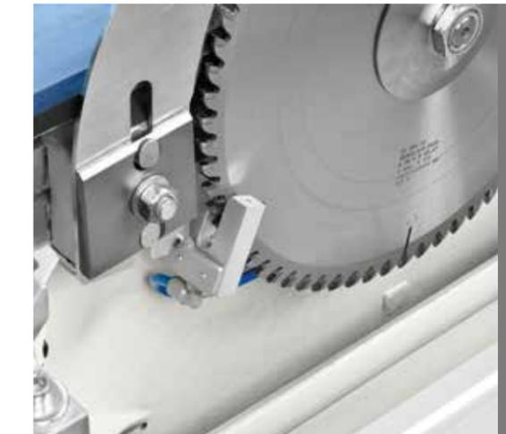
**Vorrichtung zur Mikroschmierung des Sägeblatts**
